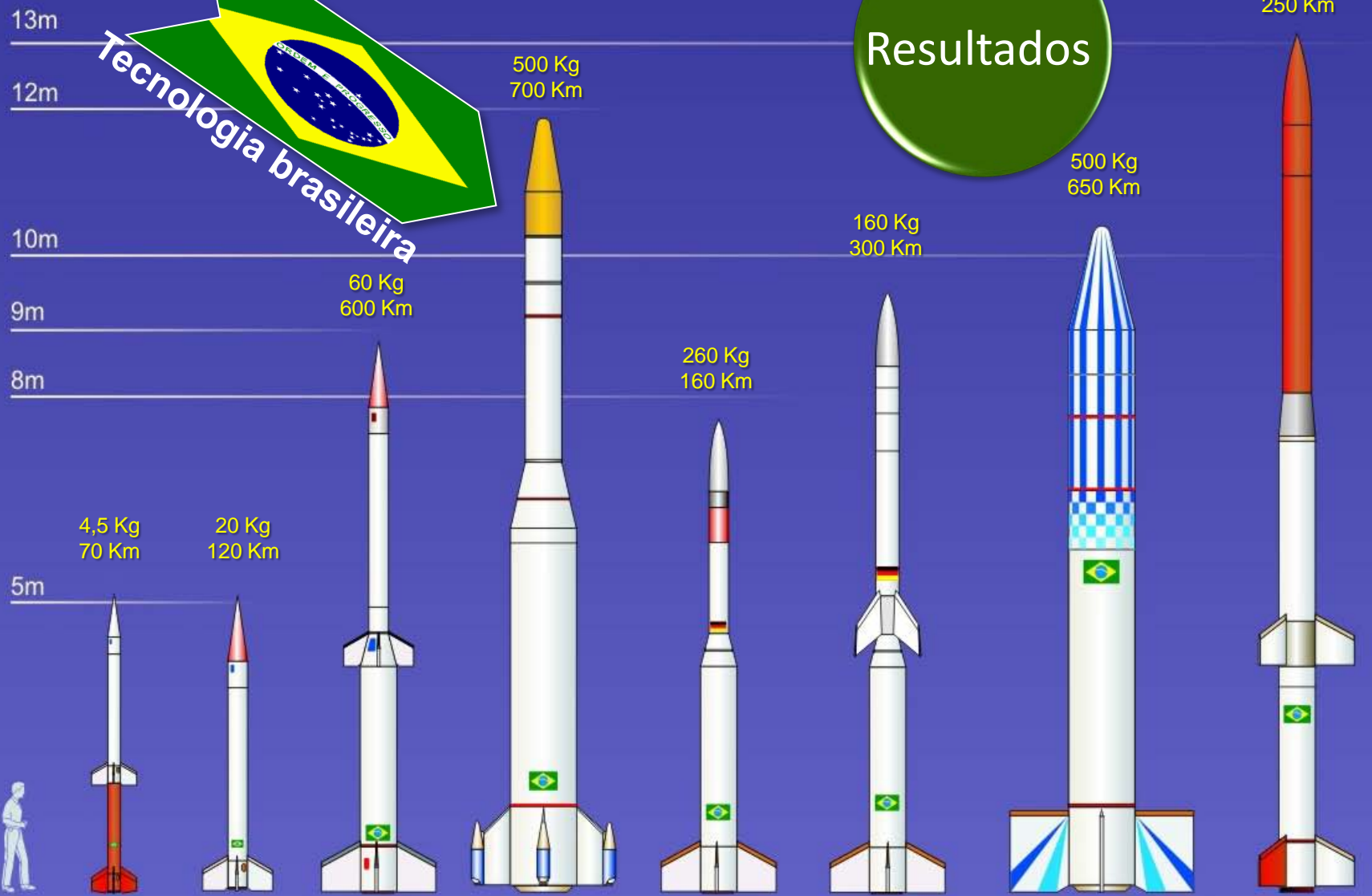
SONDA-I SONDA-II SONDA-III SONDA-IV VS-30 VS-30 ORION VS-40 VSB-30 223 61 31 4 7 3 2 11 desativado desativado desativado desativado operacional operacional operacional operacional
