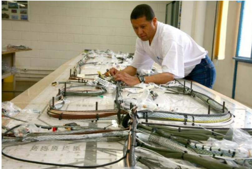
Agrupamento de cablagem
