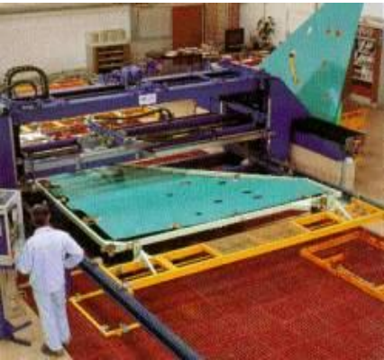
Testes automáticos de ultra-som (Non Destructive Tests)
