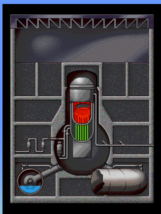
Núcleo do reator danificado – Material contido no vaso do reator
