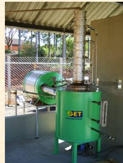
craqueador com forno metálico e pré-aquecedor
