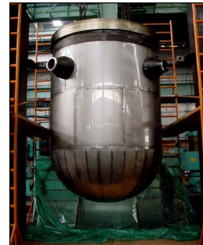
Vaso de Pressão do Reator
